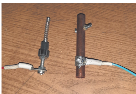
Рис. 7. Конструкция вибродатчика ВД-1
