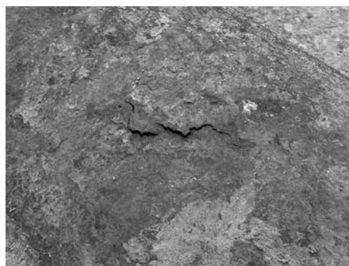
Рис. 1. Повреждение, выявленное во время отопительного периода 2016 г. в верхней части окружности трубопровода канальной прокладки магистральной тепловой сети г. Омска
