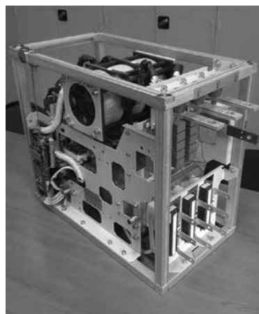
Рис. 1. Опытный образец преобразователя частоты
