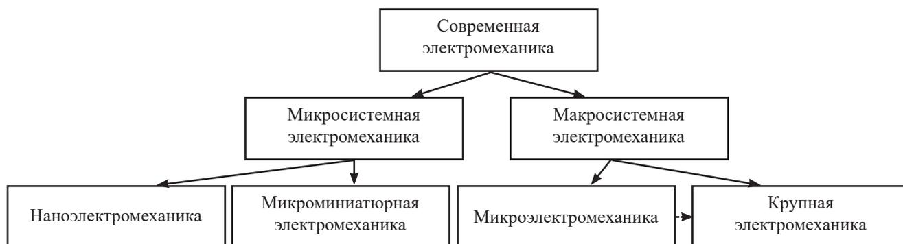
Рис. 1. Классификация электромеханических преобразователей энергии по энергетическим и массогабаритным показателям
