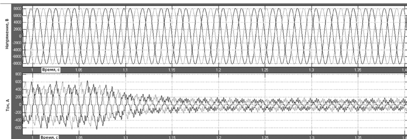
Рис. 5. Фазные токи и напряжения сети без использования АФ
