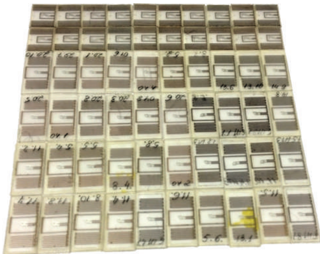
Рис. 10. Партия датчиков температуры на ПАВ с интегрированными антеннами
