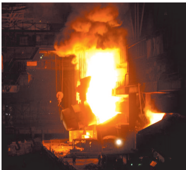
Рис. 1. Заливка чугуна в конвертер на металлургическом заводе
