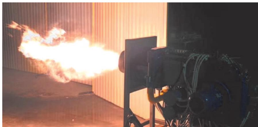
Рис. 9. Горелка на испытательном стенде
