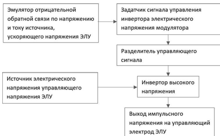
Рис. 2. Функциональная схема модели модулятора высокого напряжения смещения
