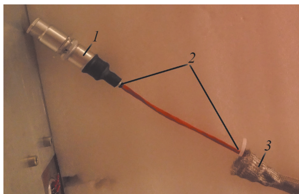
Рис. 6. Кабель с зазором между экраном и корпусом соединителя: 1 — корпус соединителя; 2 — зазор между экраном кабеля и соединителем; 3 — экран кабеля
