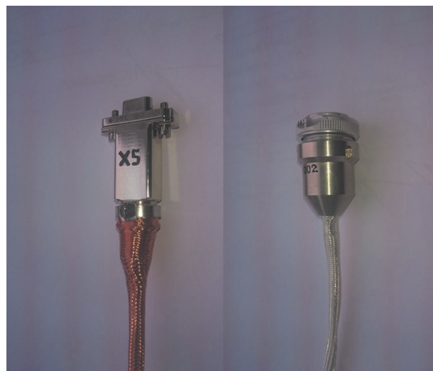
Рис. 1. Общий вид электрических соединителей с качественно закрепленным электромагнитным экраном
