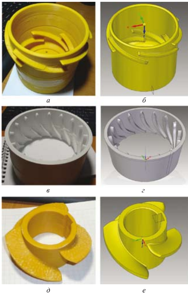
Рис. 7. Рабочие органы модели СБН и их 3D-модели: а, б — колесо рабочее; в, г — аппарат направляющий; д, е — шнек
