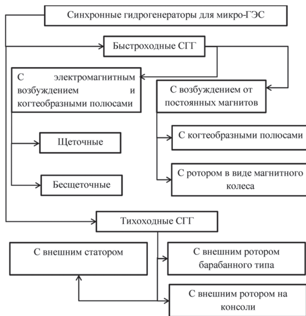
Рис. 2. Конструктивные типы гидрогенераторов для мини-ГЭС
