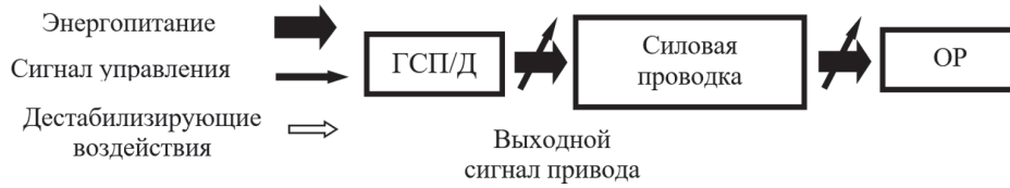
Рис. 1. Функциональное позиционирование ГСП/Д в силовой системе объекта
