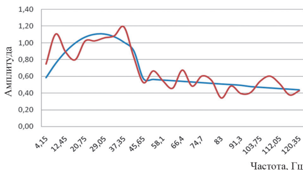
Рис. 6. Совмещенные исходная и сглаженная АЧХ (норма — 8,3 Гц):
