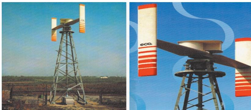
Рис. 8. Двухроторная ветроустановка ЕСО-0020 и ее ротор
