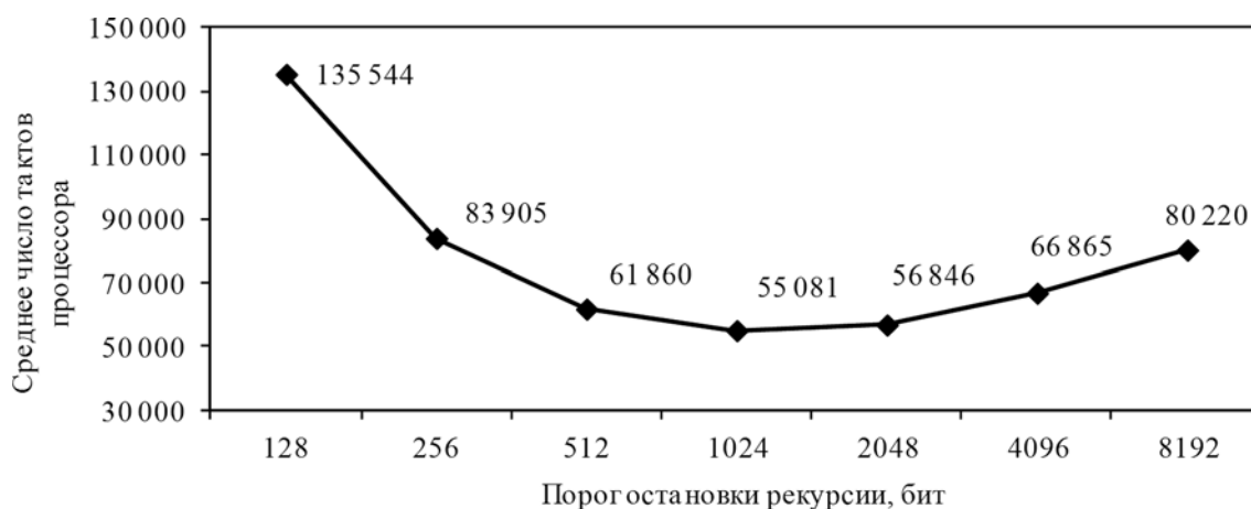
Рис. 3. Среднее число тактов процессора при вычислении произведения целых чисел разрядности 8192 бит при w = 64 бит для различных значений порога остановки рекурсии n_0 по алгоритму 3
