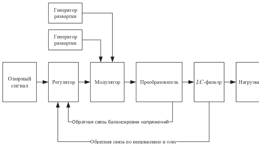
Рис. 2. Структурная схема системы управления трехуровневого инвертора
