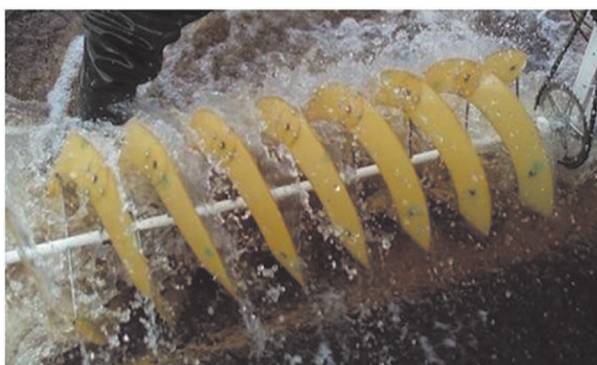
Рис. 10. Безнапорная шнековая микро-ГЭС УрФУ
