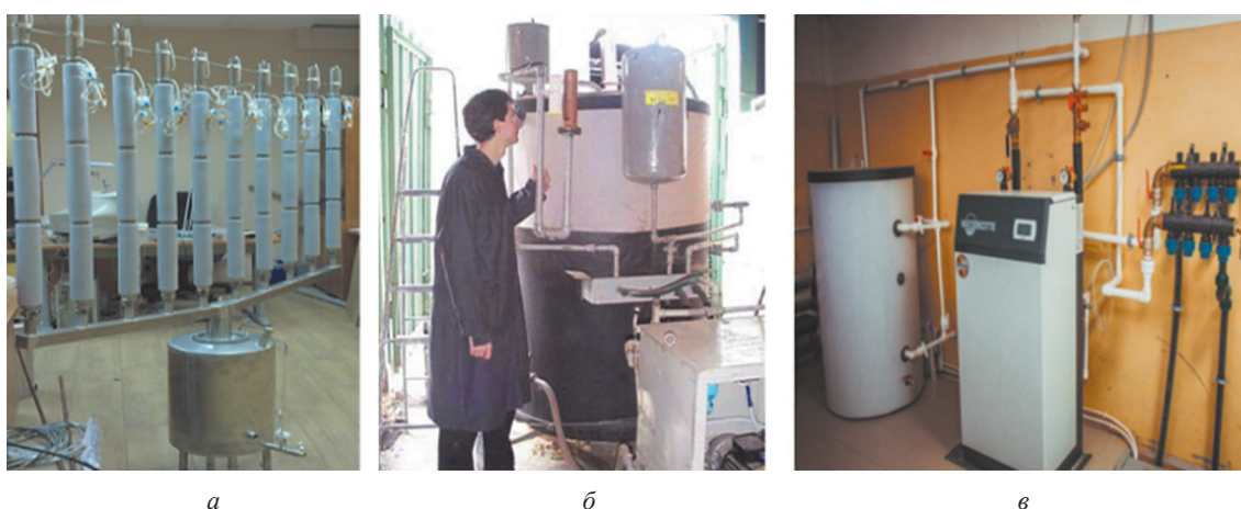
Рис. 12. Система солнечной дистилляции топливного этанола ( а ), малая биогазовая установка ( б ) и гибридная теплонаносная станция ( в )
