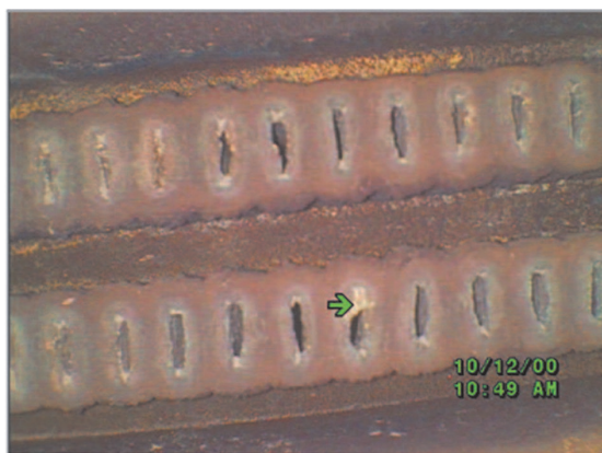
Рис. 1. Образование отложений продуктов коррозии меди на внутренней поверхности медных обмоток статоров [4]
