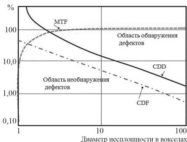
Рис. 4. Зависимости контрастной детализации и разрешения, построенные в осях относительный контраст — диаметр несплошности в вокселях
