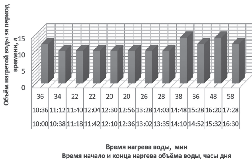
Рис. 13. Диаграмма зависимости объема нагретой воды от времени нагрева холодной воды
