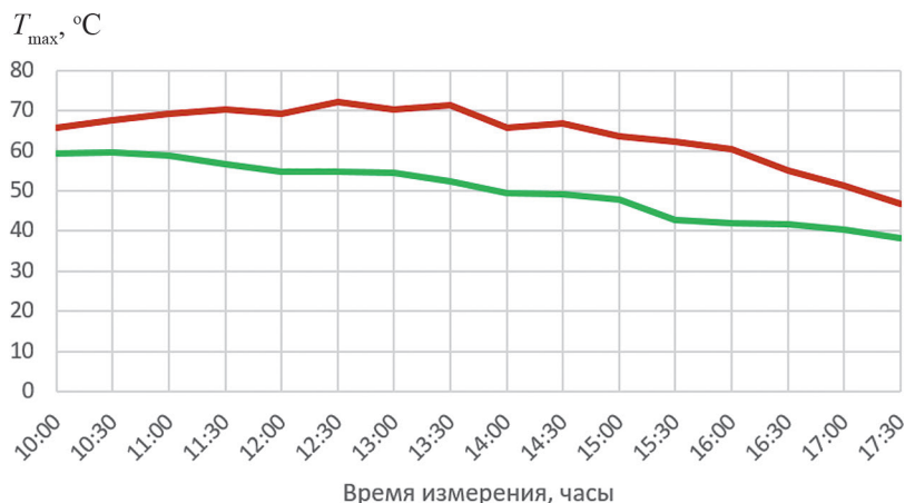
Рис. 10. Графики изменения температуры ФЭМ и ФЭТБ в течение дня:
