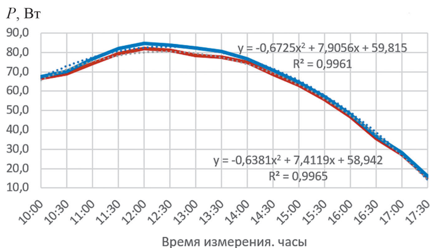
Рис. 12. Графики изменения мощностей ФЭМ и ФЭТБ в течение дня по значению коэффициента заполнения ВАХ согласно STC:
